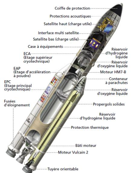
**L'étage cryogénique principal (EPC)** : comporte le moteur Vulcain ainsi que deux réservoirs d'ergols liquides. Cet étage est mis à feu dès le décollage et assure seul la propulsion du lanceur durant la deuxième phase de vol, après le largage des propulseurs. Il fonctionne en tout durant neuf minutes.
